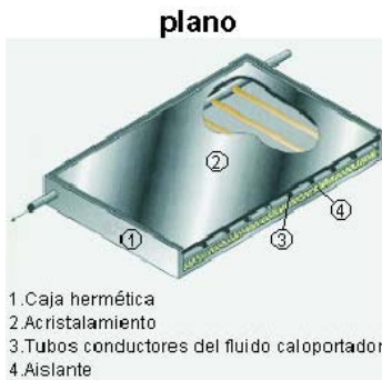
Figura 14. Esquema de captador plano.
