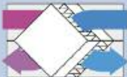
Transferencias de calor de placas de corrientes cruzadas
