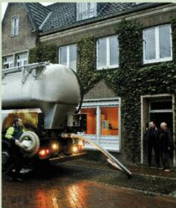
Suministro de pelets con el vehículo-cisterna
