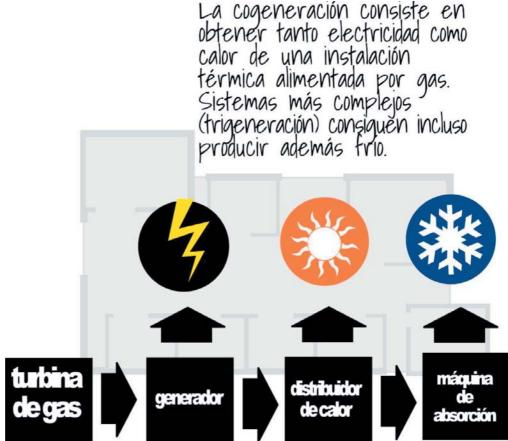
La cogeneración consiste en obtener tanto electricidad como calor de una instalación térmica alimentada por gas. Sistemas más complejos (trigeneración) consiguen incluso producir además frío.
