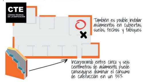
Paredes, suelos y techos pueden volverse «impermeables» a la transmisión de calor mediante diversas técnicas. Existen soluciones interiores, de inyección de material aislante en la estructura del muro, o mediante la colocación de paneles exteriores.
