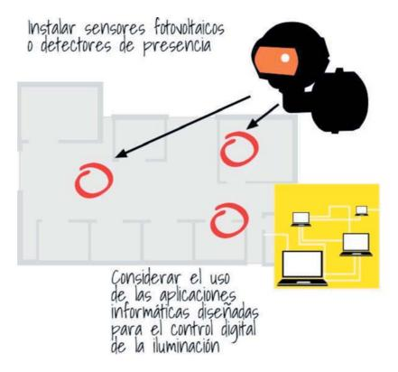
La regulación automática de la iluminación se debe integrar en un sistema «inteligente» de gestión de la energía (ver la medida «Instalar sistemas inteligentes de gestión de la energía», en el apartado *Medidas de carácter general*). Tiene especial importancia ajustar el flujo luminoso artificial de acuerdo con el nivel de luz solar disponible.
