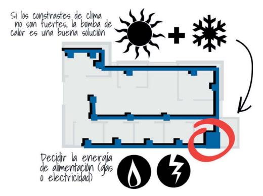
La bomba de calor es un sistema muy eficiente basado en la extracción de energía útil del aire ambiente. De esta forma, es capaz de devolver dos o tres veces más energía útil (en forma de calor o frío) que la que recibe en forma de electricidad o gas natural.
