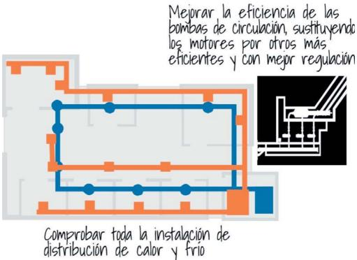
Uno de los principales yacimientos de energía desaprovechada se encuentra en los conductos que distribuyen calor y frío por toda la instalación. Su gran longitud hace que la superficie por la que pueden perder calor o frío sin provecho sea muy grande. Un adecuado revestimiento aislante puede resolver el problema. Al mismo tiempo, mejorar la eficiencia de las bombas de impulsión del agua también contribuye mucho a reducir las pérdidas inútiles de energía en el sistema de distribución.
