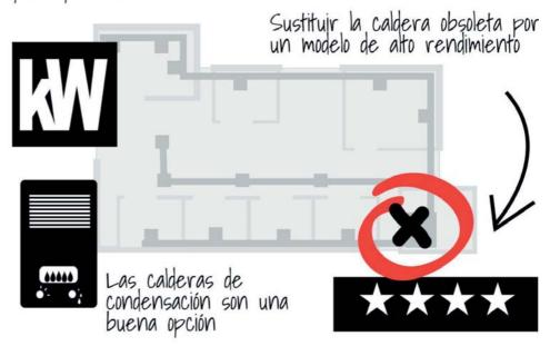
Las calderas de alto rendimiento son máquinas que entregan un altísimo porcentaje de calor útil a cambio del combustible que se quema en su interior. Alcanzan su máxima eficacia en combinación con conductos de calor y radiadores de alta eficiencia, así como de un buen sistema de sensores de la temperatura ambiente.
