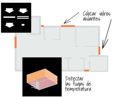
Desde el punto de vista del aislamiento térmico, puertas, ventanas y acristalamientos son puntos débiles de la envolvente del edificio. Pero existe la tecnología para convertirlas en verdaderos muros transparentes.
