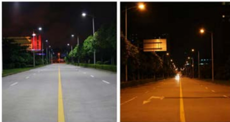
Figura 2.20. Comparación LED y HPS.
