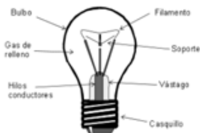
Figura 2.13. Esquema de una lámpara incandescente.
