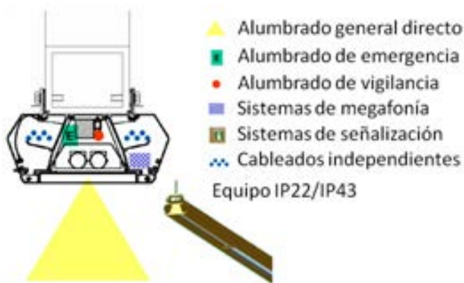
Figura 4.13. Esquema de la luminaria.
