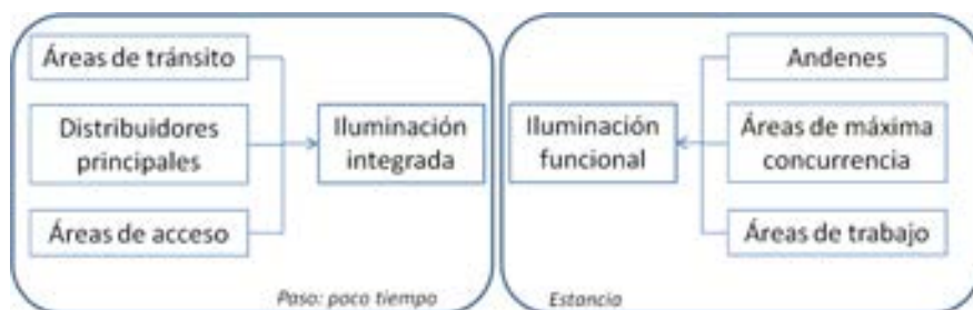
Figura 4.9. Iluminación integrada y funcional.
