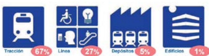
Figura 6.3. Gastos energéticos. Fuente: Metro de Madrid.
