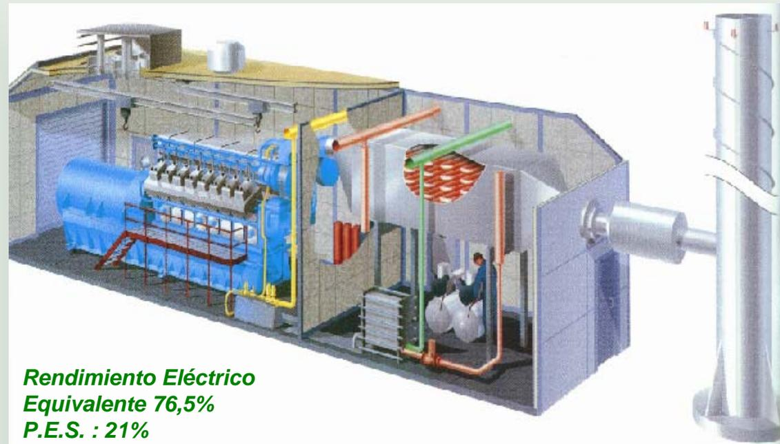
La cogeneración consiste en la producción simultánea de energía eléctrica (o mecánica) y energía térmica útil a partir de combustible, asegurando su propio abastecimiento energético, con calidad, ahorrando energía y dinero.
